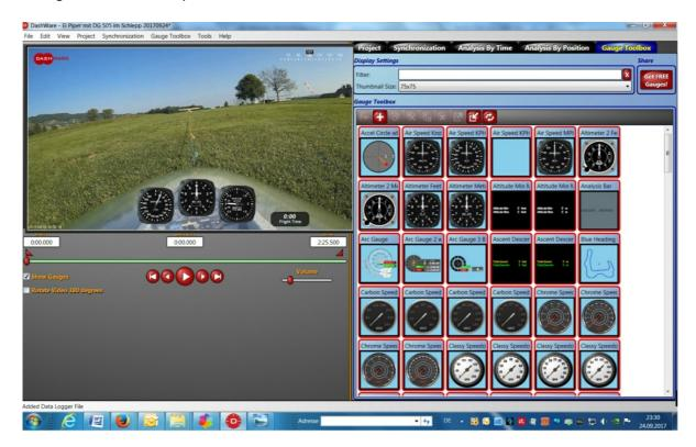
Die Werte, die mit den Instrumenten dargestellt werden sind real. Im Beispiel von meinem Video habe ich die Geschwindigkeit in km/h, die Höhe in Meter, das Vario in 1000 feet / min, die Flight Time und das Tape Heading (Kompass oben rechts) gewählt.
